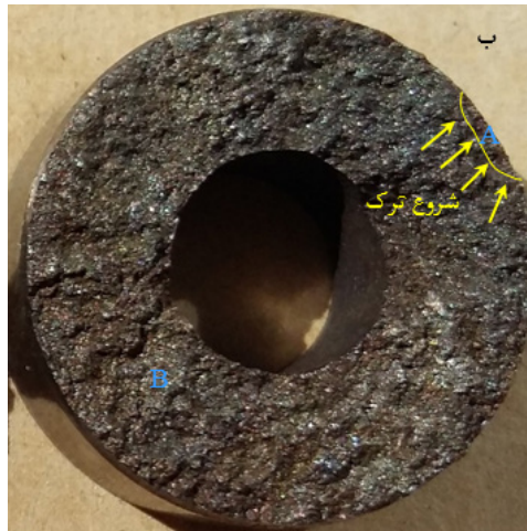
شکل ۴: تصاویر میکروسکوپی سطح شکست؛ (الف) نمونه‌ی ۱، و (ب) نمونه‌ی ۲.
