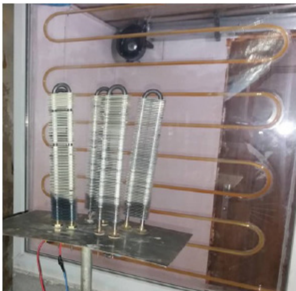
شکل ۶: استفاده از المنت‌های الکتریکی به منظور شبیه‌سازی شرایط بیرون در تابستان
