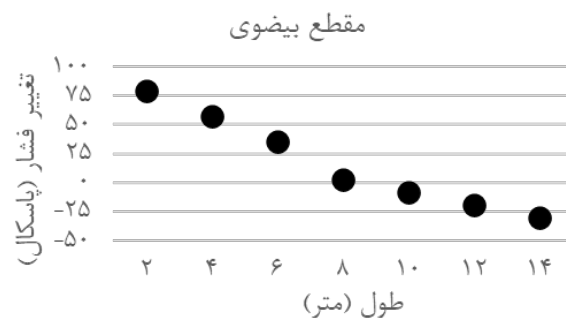
شکل ۱۱: تغییرات فشار وارده بر ساختمان بر حسب تغییرات طول آن در مقطع بیضی‌گون
