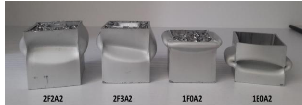
شکل ۲: تغییر شکل نهایی و لهیدگی نمونه‌های موردنظر تحت آزمون ضربه محوری
