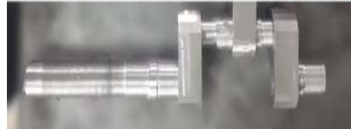
شکل ۳: لنگ طراحی شده در نرم‌افزار CATIA (بالا) و مدل ساخته شده (پائین)
