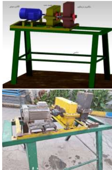
شکل ۱: اجزاء سامانه شامل الکتروموتور، جعبه دنده، مکانیزم بار مقاوم و شاسی، بالا: مدل طراحی شده و پایین: مدل ساخته شده
