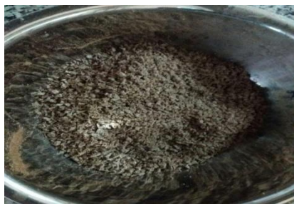
شکل 3: گرانول‌های آماده‌شده با استفاده از دستگاه خردکن
