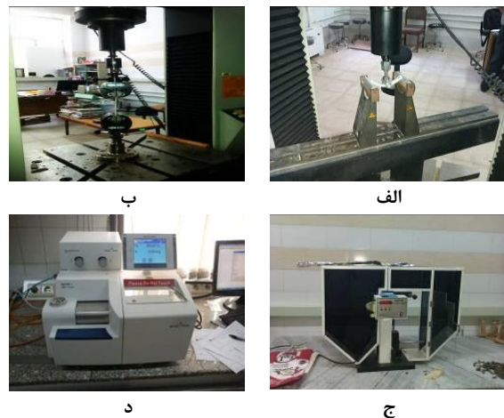
شکل 6: (الف) دستگاه Instron جهت آزمون خمش، (ب) دستگاه Instron جهت آزمون کشش، (ج) دستگاه آزمون ضربه Zwick، (د) دستگاه آنالیز حرارتی
