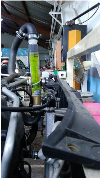
شکل ۲: محل و چگونگی نصب روتامتر در سیستم آزمایشگاهی
