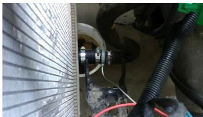
الف: سنسور دمای خروجی رادیاتور
