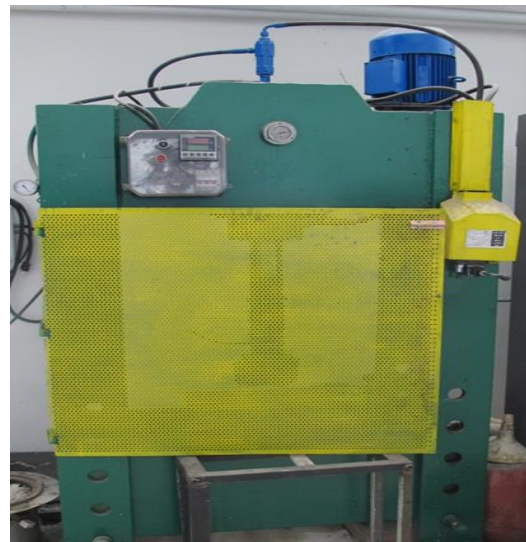
شکل ۷: پرس هیدرولیک ۱۰۰ تن مجهز به سنسور تنظیم و نگاهداری فشار
