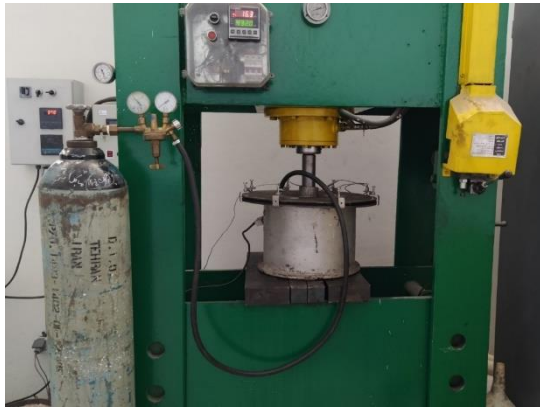
شکل ۸: سیستم پرس داغ تحت اتمسفر خنثی
