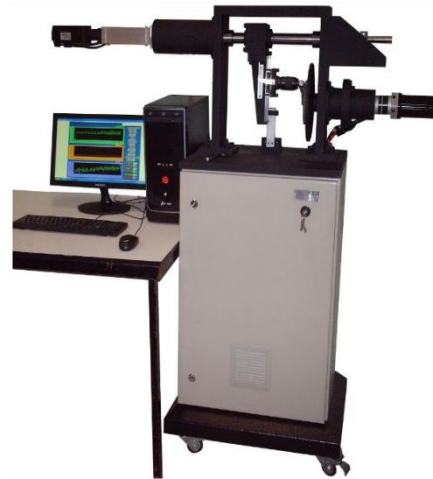
شکل ۹: دستگاه آزمون سایش به روش پین روی دیسک
