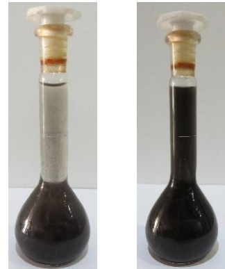
شکل ۴: پایداری بصری نانوسیال اکسید آهن/آب مقطر با غلظت ۰/۱۵٪ بعد از ۱ و ۲۴ ساعت
