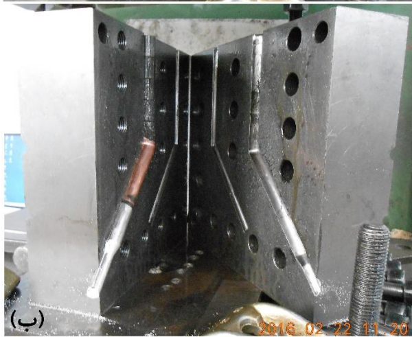
شکل ۲: نمایی از پیکربندی قالب (الف) پیش و (ب) پس از اعمال فرآیند ایکپ گرم همراه با اعمال فشار پشتی
