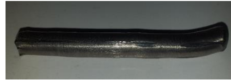
شکل ۳: نمایی از بیلت تیتانیومی جداشده از غلاف بعد از اعمال ۴ گذر ایکپ گرم همراه با فشار پشتی
