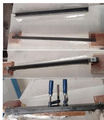
شکل ۱: مراحل تولید چسبنده‌های U شکل
