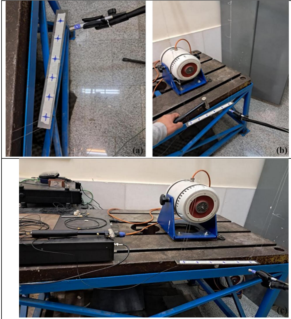
شکل ۳: (a) چیدمان آزمایش برای تیر دوسر آزاد، (b) تحریک تیر در شش گره متوالی، (c) اندازه‌گیری پاسخ با دستگاه تحلیل گرد شبکه
