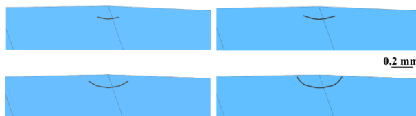
شکل ۱۰: چند مرحله از رشد ترک زیرسطحی
