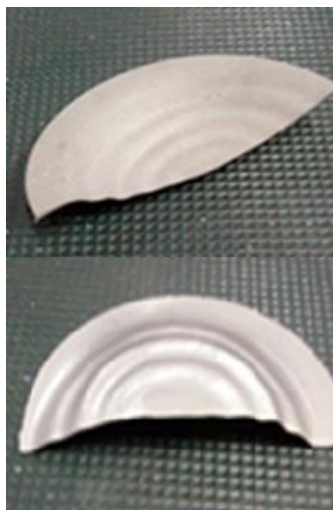
شکل ۶: نمونه شکل داده شده با فشار ۸۰ بار، نازل ۲/۷ میلی‌متری و پیشروی ۲/۴ میلی‌متر بر دقیقه
