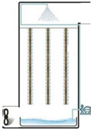
شکل ۱: طرحواره خنک‌کننده تبخیری با سطح‌های مرطوب
