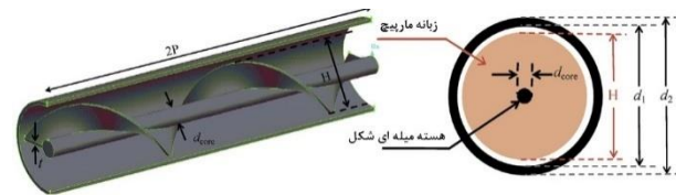
شکل ۵: شماتیک لوله جاذب با توربولاتور ماریچج حلزونی [۶۴]
