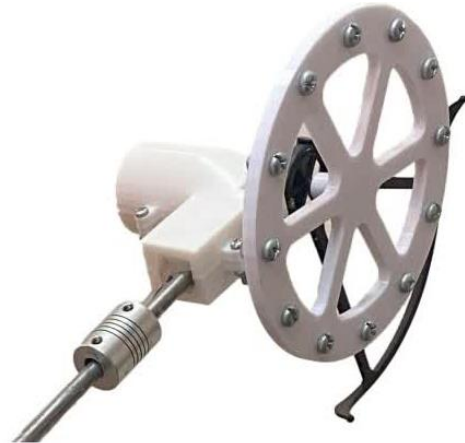
شکل ۳: نمایی از عملگر چرخ عکس‌العملی ساخته شده
