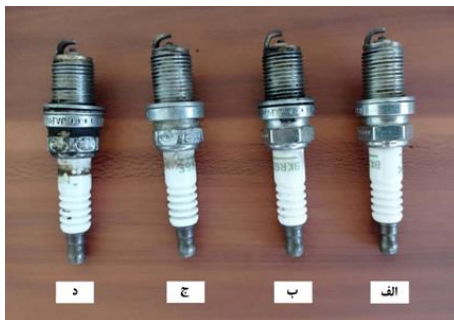
شکل ۲: نمایی از نمونه شمع‌های مورد استفاده برای آزمایش دارای کارکرد به ترتیب (بر حسب هزار کیلومتر):
