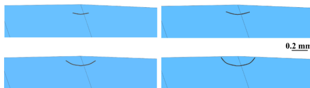
شکل ۱۰: چند مرحله از رشد ترک زیرسطحی
