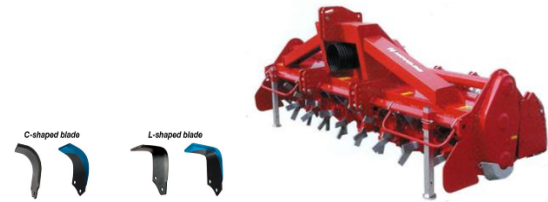
شکل ۱: نمای یک روتیواتور و تیغه‌های C و L
