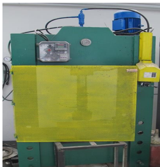
شکل ۷: پرس هیدرولیک ۱۰۰ تن مجهز به سنسور تنظیم و نگهداری فشار
