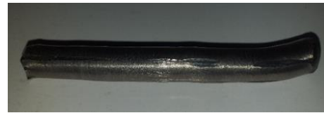
شکل ۳: نمایی از بیلست تیتانیومی جداشده از غلاف بعد از اعمال ۴ گذر ایکپ گرم همراه با فشار پشتی
