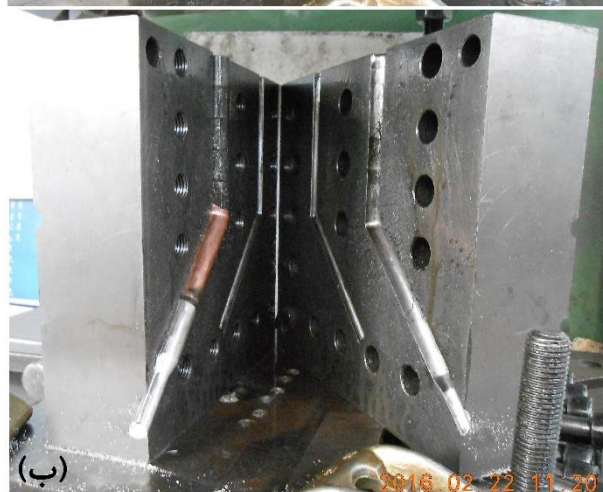
شکل ۲: نمایی از پیکربندی قالب (الف) پیش و (ب) پس از اعمال فرآیند ایکپ گرم همراه با اعمال فشار پستی
