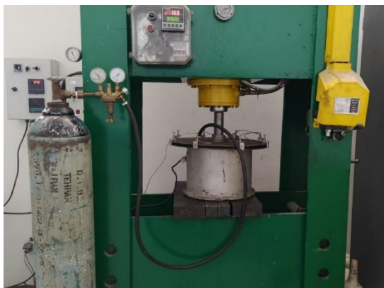
شکل ۸: سیستم پرس داغ تحت اتمسفر خنثی
